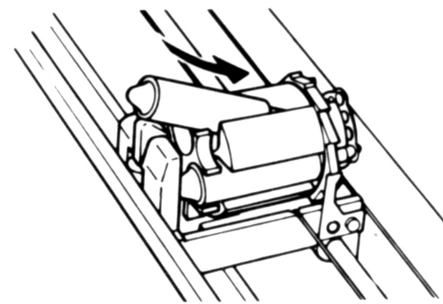
3) Mettre sous tension et appuyer sur la touche de changement de couleur (☰). La tête d'impression tournera et le prochain porte-plume se présentera en haut. installer la prochaine plume dans ce porte-plume. Répéter ces opérations jusqu'à ce que toutes les plumes aient été installées.
