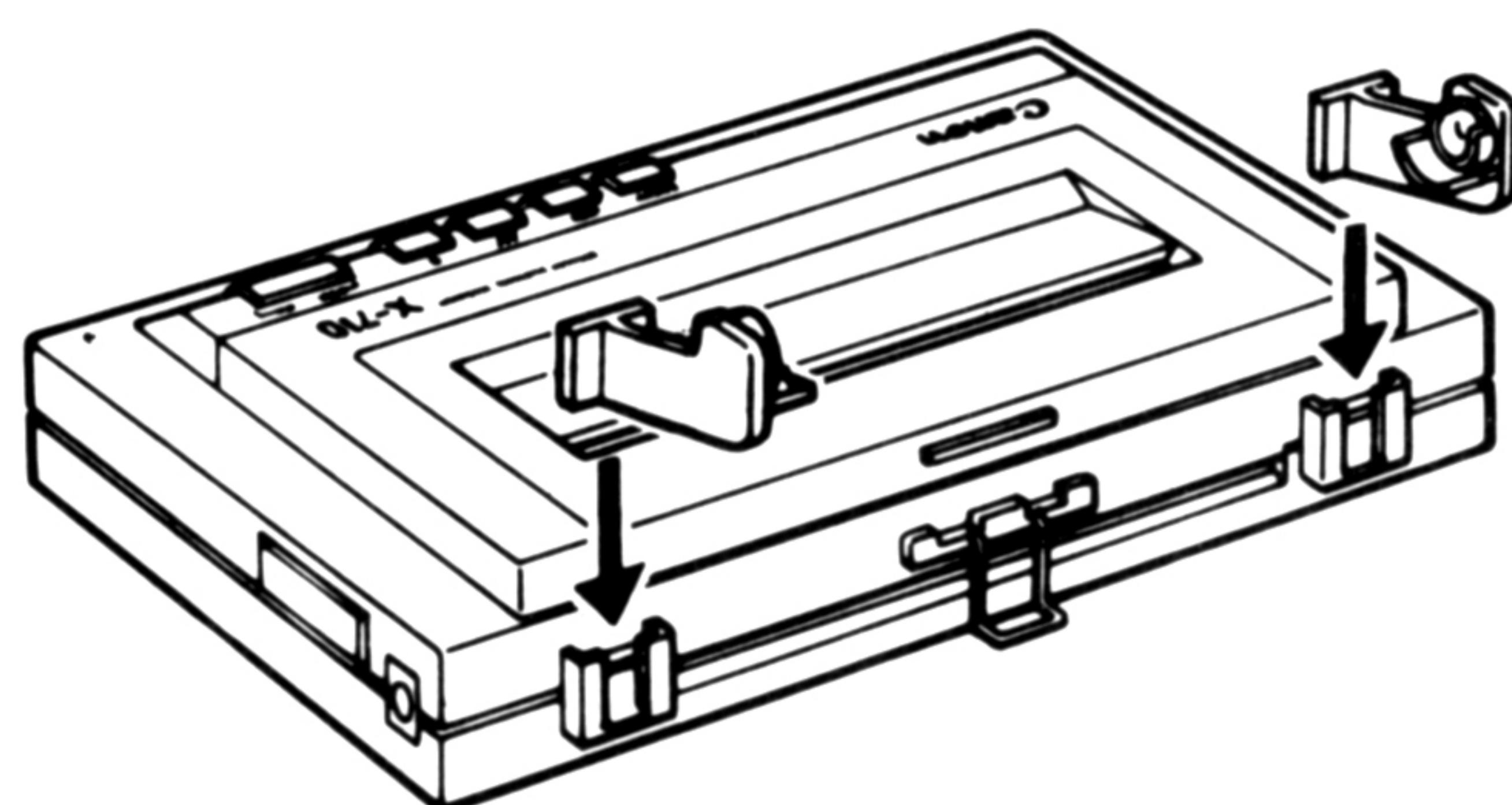
2) Sortir les plumes de l'axe de rouleau de papier et en retirer les capuchons. Laisser les capuchons dans l'axe. Retirer le couvercle de l'imprimante et poser la plume sur le porte-plume (de même couleur qu'indiqué à côté de ce dernier) de la manière illustrée ci-dessous.
